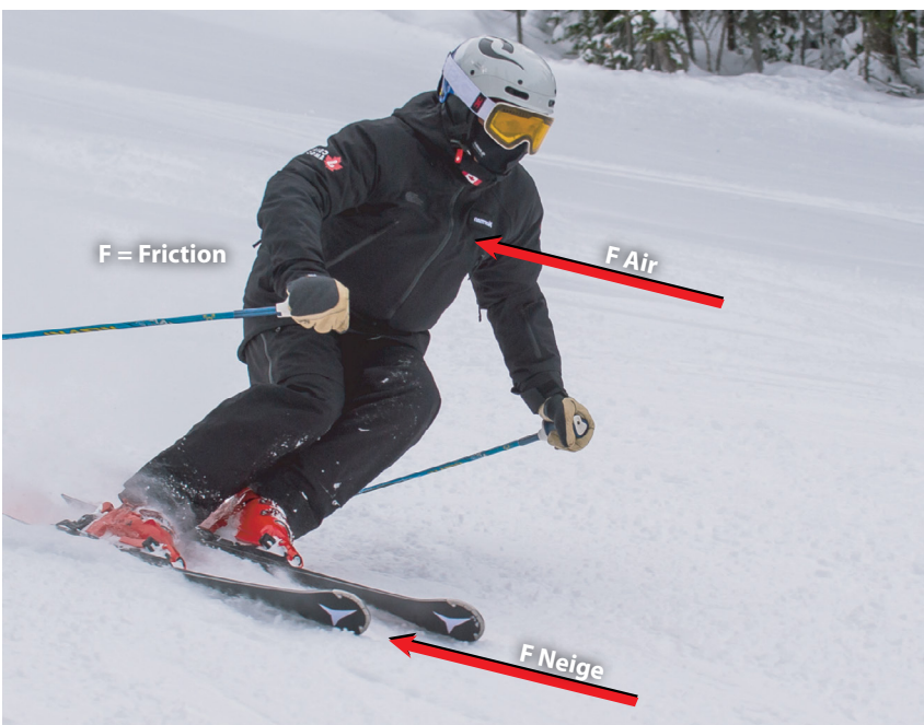
Figure 5 : Les composantes des forces de la friction de la neige et de l'air ( F_{\text{Neige}} et F_{\text{Air}} ).
